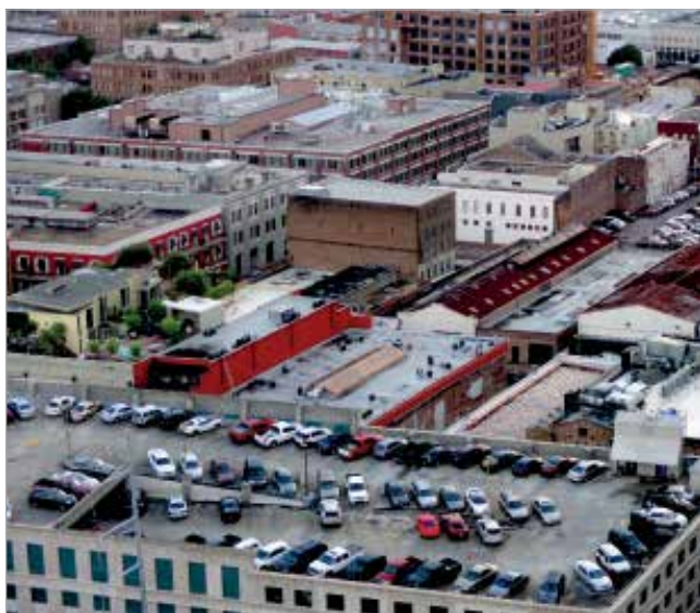
Ein Quartier in New Orleans als abschreckendes Beispiel: Alle Böden sind versiegelt (asphaltiert) und das Regenwasser fliesst sofort durch die Kanalisation ab, Dächer sind nicht begrünt, Böden und Gebäudemauern speichern Sonnenwärme, Klimaanlage auf den Dächern erzeugen Abwärme, hohe Häuser und dichte Bebauung behindern die Durchlüftung, die Autoabgase belasten das Mikroklima. Die wenigen Bäume und Büsche links im Mittelgrund können zwar Wasser speichern und die Luft reinigen, aber sie stehen auf ziemlich verlorenem Posten. Bild/Text: Veronika Meyer.
